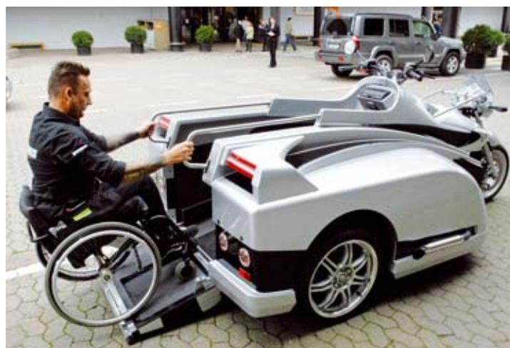
Das Trike besitzt sechs Gänge sowie einen Rückwärtsgang. Hydraulisch geregelte Scheibenbremsen vorne und hinten sind über einen Hebel zu bedienen.
